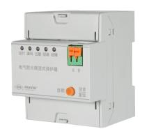
FT-EFP20A 电气防火限流式保护器是凡特专门为了保护低压配电线路中短路、过载等问题研发,单相线路保护,额定电流 20A。可以有效克服传统断路器、空气开关和监控设备存在的短路电流大、切断短路电流时间长、短路时产生的电弧火花大,以及使用寿命短等弊端,发生短路故障时,能以微秒级速度快速限制短路电流以实现灭弧保护,从而能显著减少电气火灾事故,保障使用场所人
