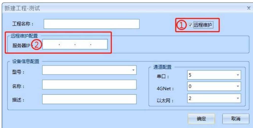
工程新建过程中也可跳过以上步骤，远程服务器 IP 也可后期直接在工程配置信息界面增加及修改，如下图：（注：服务端口不用填，默认 16008）
