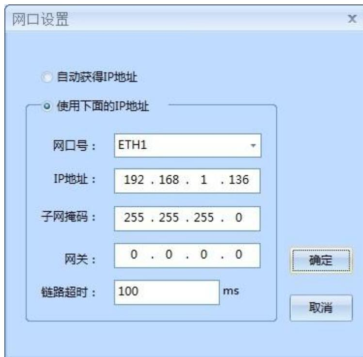
如果当前工程中没有配置 4G 通道，则工程中的网口通道参数支持设置网口为自动获取 IP 及固定 IP 地址方式，ETH1 对应设备网口 LAN1 或 LAN。
