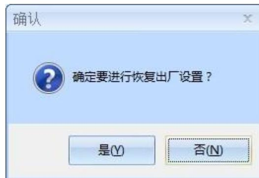
执行“是”之后，设备将自动恢复得到出厂设置状态，此时设备的 IP 地址将更改为 192.168.1.136 (LAN1) 及 192.168.2.136 (LAN2)，需要重新进行设备的配置管理工作。
