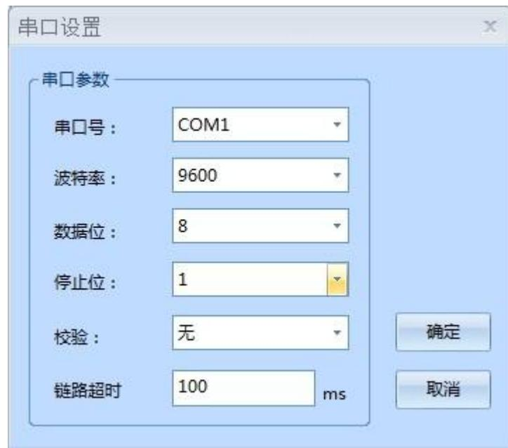
支持对串口各种参数进行合理配置，串口号 COM1 对应设备 A1、B1。
