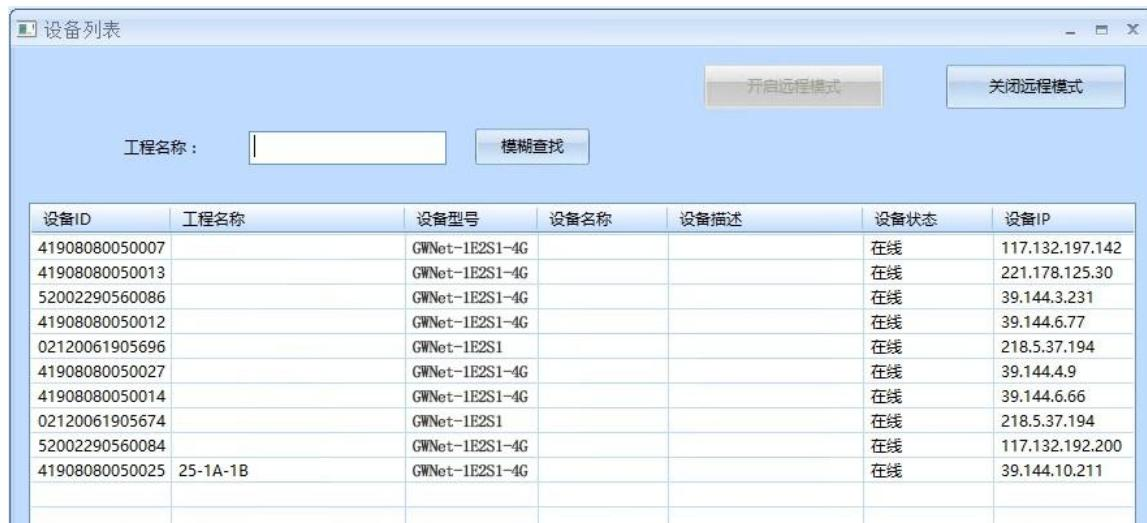
在设备列表中选中需要远程的通信管理机，右击【开始管理】，如下图：设备进入远程管理模式，之后可以关闭设备列表，对设备进行远程维护（包括更新配置、读取工程、设置时钟、本地升级、在线监视等）。若要切换设备进行远程管理，则再次打开设备列表，在设备列表中选中当前正远程管理的设备，右击【停止管理】，然后选择需切换的设备进行远程管理。
