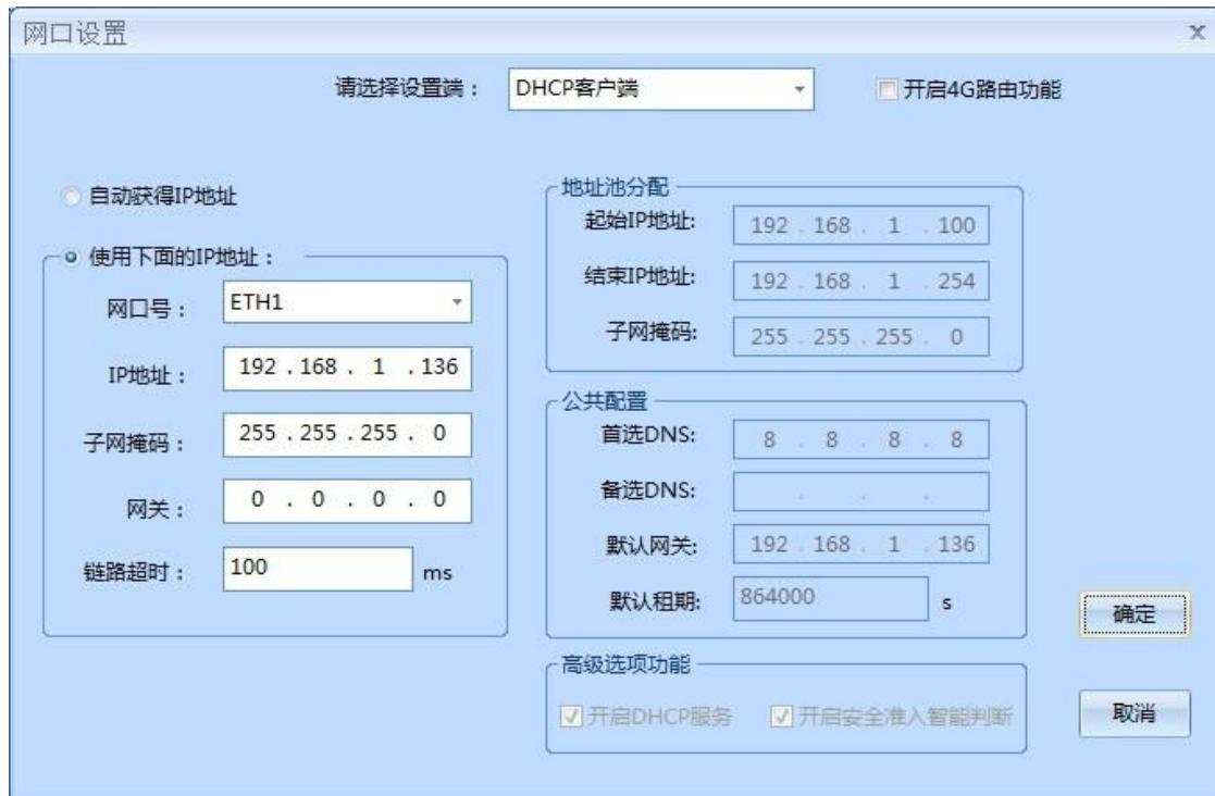
如果当前工程中有配置 4G 通道，则工程中的网口通道参数可配置为 DHCP 客户端模式和 DHCP 服务端模式，当配置为 DHCP 服务端模式时，提供对地址池及高级功能项配置的功能。
